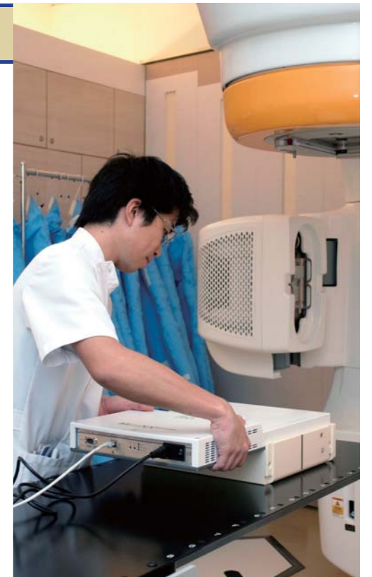
IMRT検証用測定機器の設置
